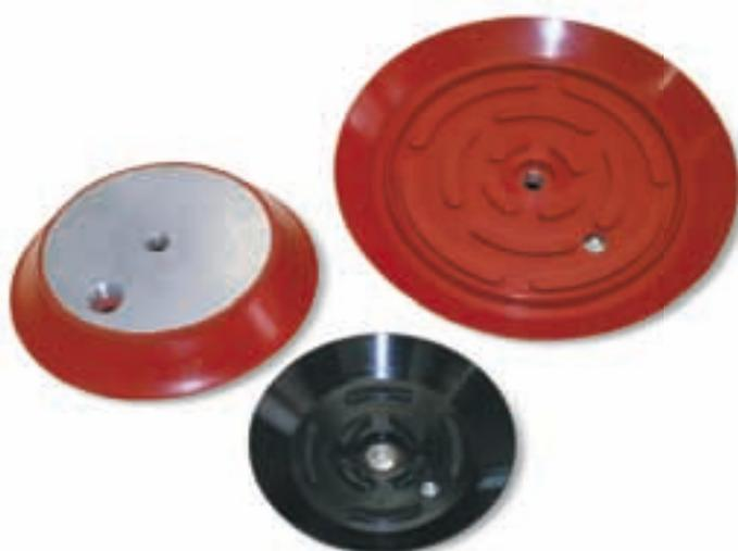
Cette série de ventouses a été conçue pour le levage et la manutention de grosses charges, aussi bien horizontal que vertical. Vulcanisées sur un support en acier, elles ont un trou fileté central pour la fixation sur l'automatisme et un autre latéral pour la connexion du vide.
